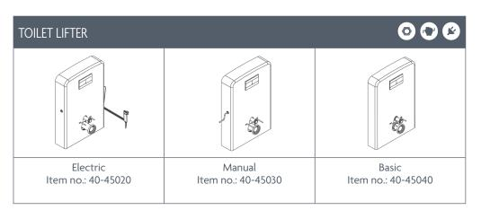
$Toilet\ lifter\ unit\ in\ bottom\ position:\ Model\ Electric/Manual\ 118\ x\ 79\ x\ 20,5\ cm\ and\ Model\ Basic\ 118\ x\ 79\ x\ 16,5\ cm.$
