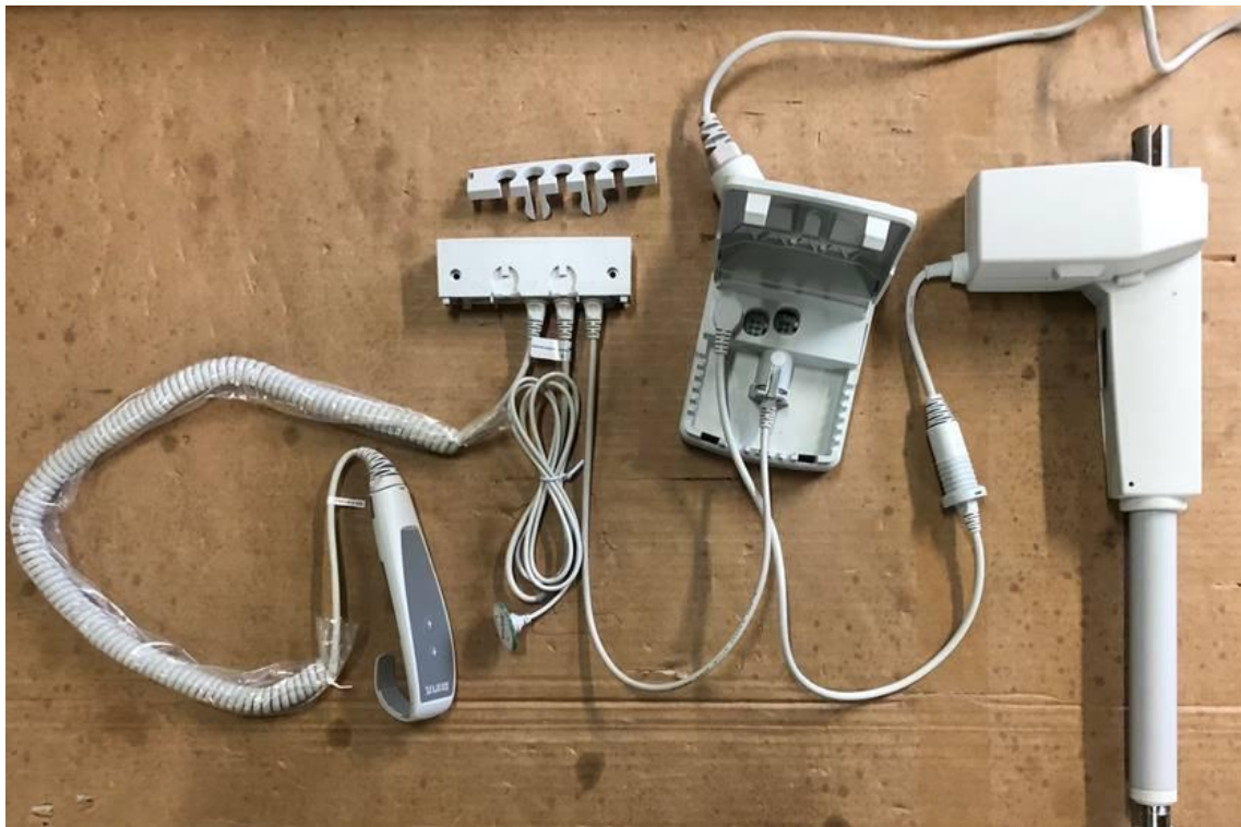
Kabelplan mit beiden Steuerungen
