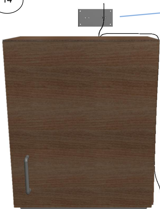
Monteer kabelontlasting voor netsnoer aan de muur
