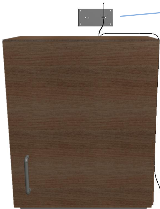
Kabelentlastung für Netzkabel an Wand montieren
