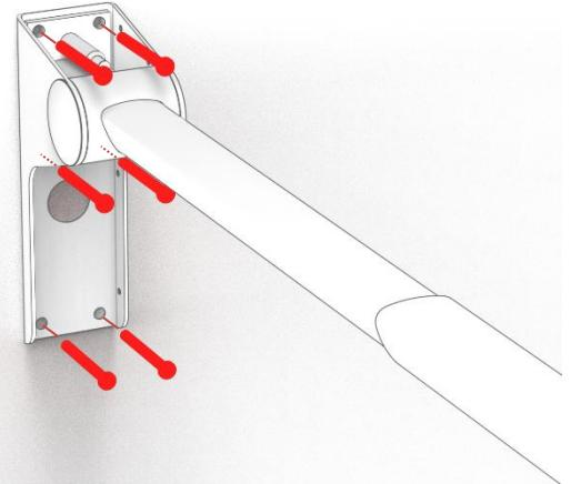
3. Schrauben Sie den Toilettenstützarm an die Wand.
