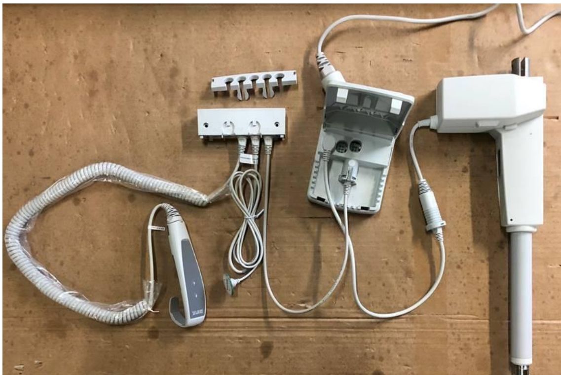
Kabelplan mit beiden Steuerungen
