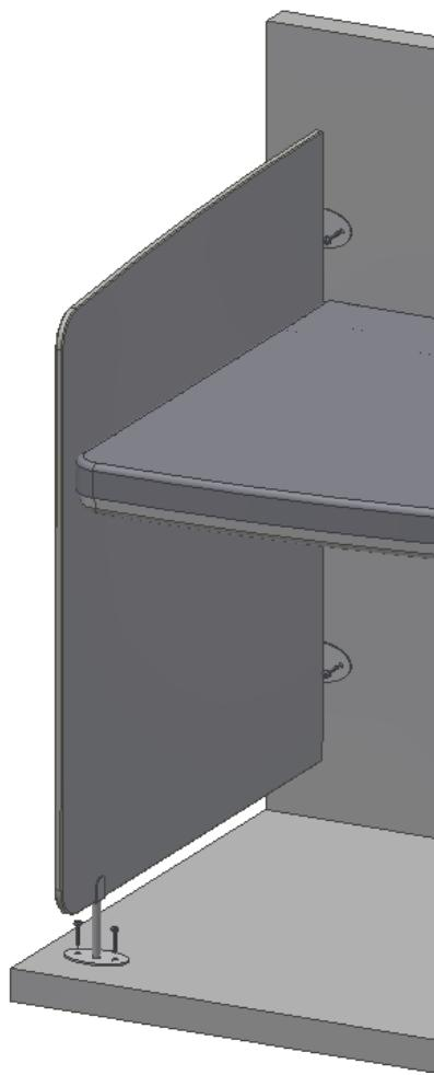
4. Dübel und Bolzen in den 6 Löchern montieren.
