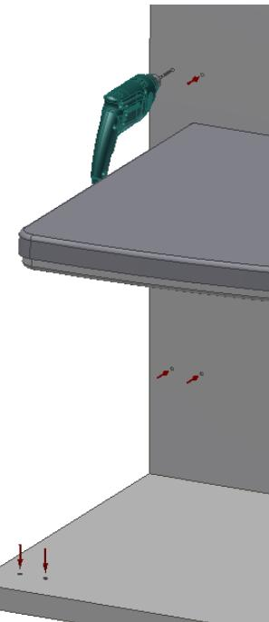
3. Löcher in Wand und Boden bohren.
