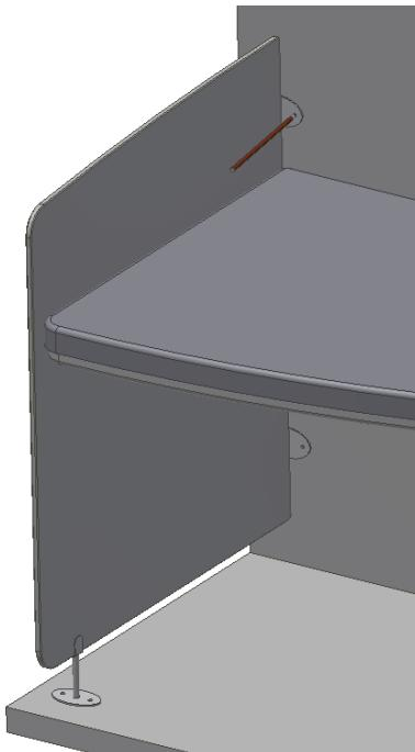
2. Durch die 3 Montageschläge an Wand und auf Boden Löcher markieren.
