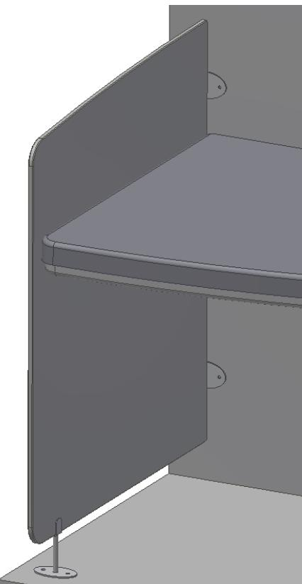
1. Die Seitenabdeckungen neben dem Wickeltisch anbringen, so dass keine Einklemmgefahr besteht.
