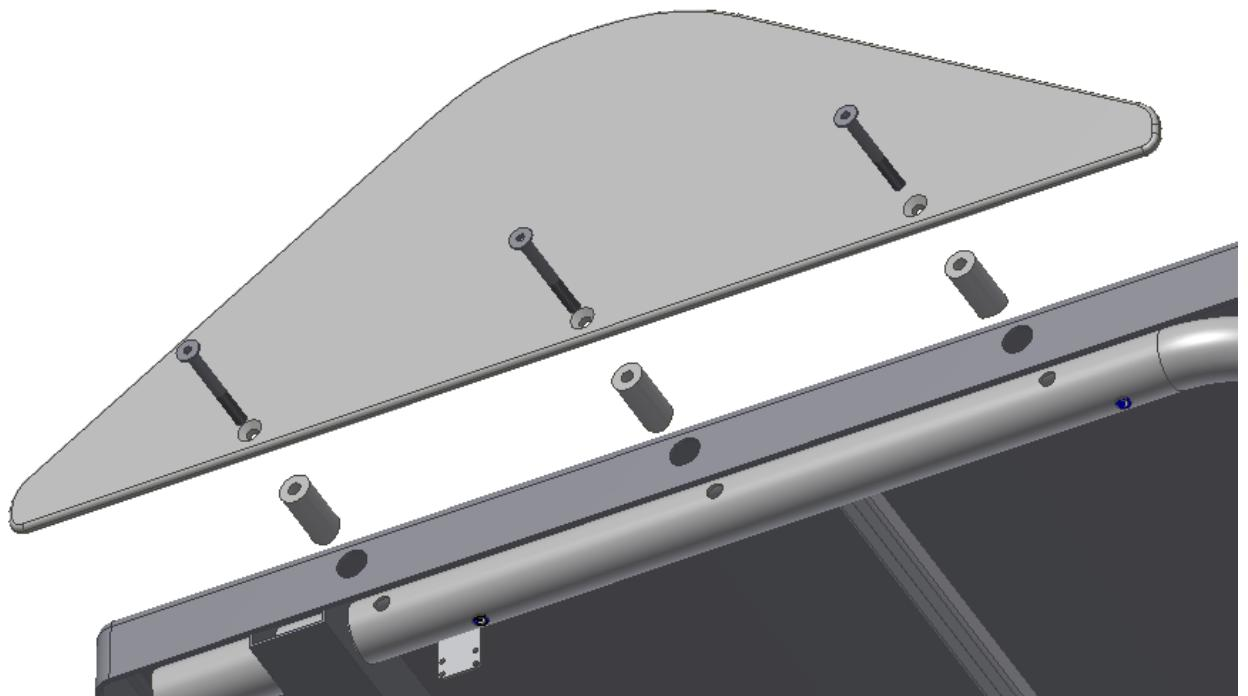
4. Die Seitenabdeckung in den oberen Rahmen durch die 3 Löcher mit Bolzen befestigen.
