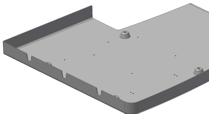
2. Gemäß den untenstehenden Abmessungen 3 Einschnitte in der Bodenplatte schneiden.
