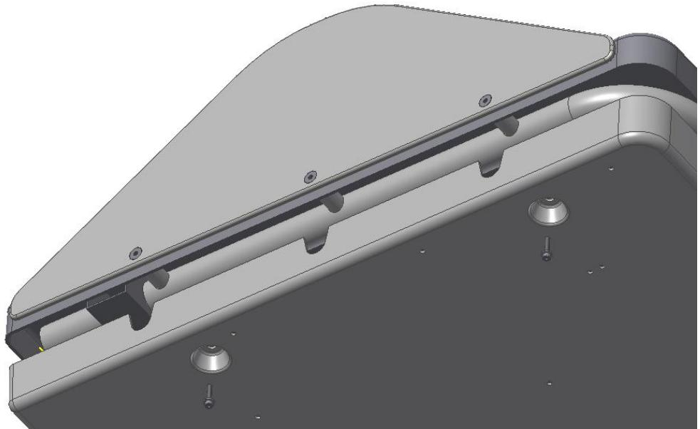
5. Die Bodenplatte mit den 6 Montagebolzen wieder montieren.
