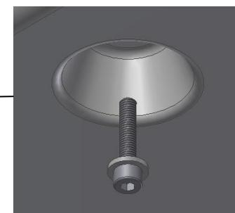
1. Die 6 Bolzen für Befestigung der Bodenplatte an der Tischplatte entfernen.
