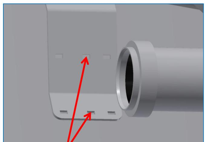
Der Kabelbinder wird durch diese Löcher geführt
