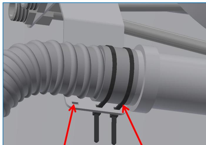
Bei Bedarf kann ein dritter Kabelbinder verwendet werden
