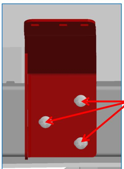
Die Halterung kann durch Lösen dieser 3 Schrauben seitlich verstellt werden
