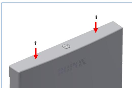
3. Die Tischplatten-Einheit kann nun auf die Hubeinheit montiert werden. Die Tischplatten-Einheit wird vormontiert geliefert.
