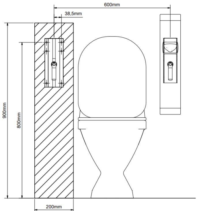
Die Einheit wird mit einem Satz (6 Stück) von Schrauben und Dübeln geliefert, die für die Montage an einer Betonwand vorgesehen sind. Der Monteur muss immer das Material, die Beschaffenheit und die Festigkeit der Wand beurteilen und geeignete Schrauben und Dübel für diese konkrete Art von Wand verwenden.
