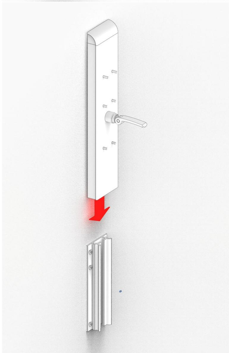
4. Montieren Sie die Verriegelungsplatte mit den beiden Schrauben an der Unterseite der Fronthalterung.
