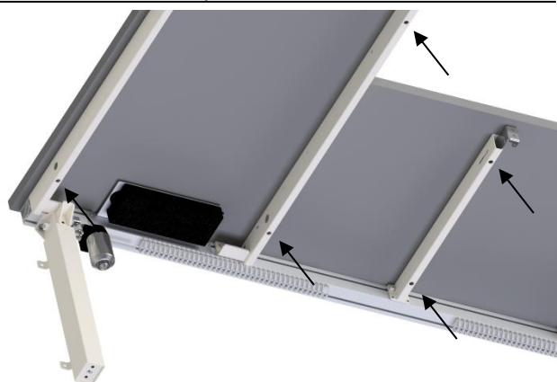
4.7.1 På de yttersta bordsskivans stöd rekommenderas att de främre kantfästena pekar mot ramens mitt så att de inte kommer i konflikt med träkanten på sidan.
