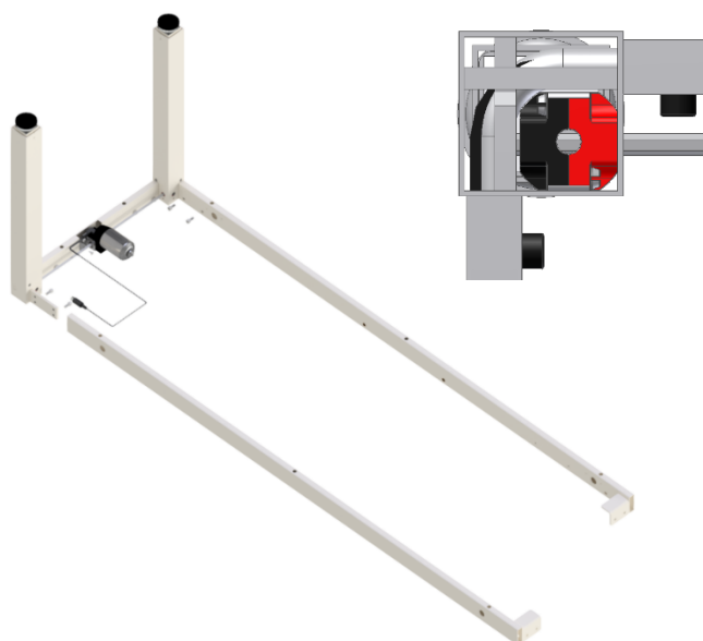
4.4.4 Montera de långa skenorna med M8x16-skruvar. Det är mycket viktigt att alla skenor trycks ordentligt mot benet innan de dras åt. Se till att dra åt skruvarna ordentligt.
