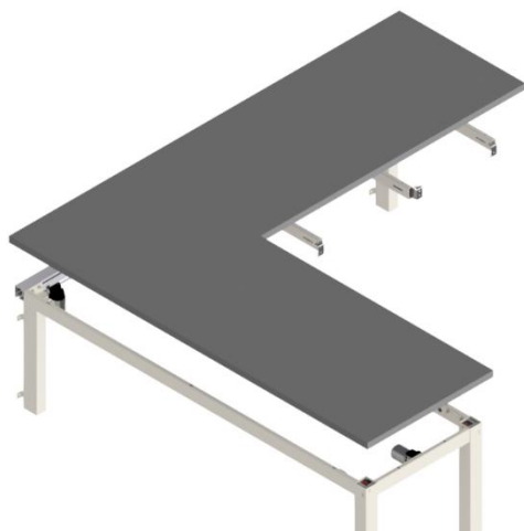
4.7.2 Bordsskivan är nu placerad på ramen. Det får vara ett maximalt avstånd på 0,5 cm från bordsskivans baksida till väggen. Övriga avstånd på bordsskivan ska mätas enligt den mottagna ritningen.
