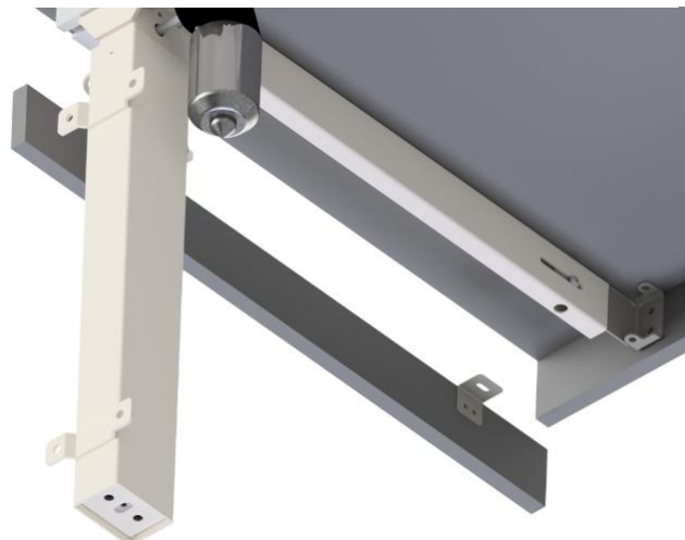
4.7.2 Het tafelblad wordt nu op het frame geplaatst. De afstand tussen de achterkant van het tafelblad en de muur mag maximaal 0,5 cm bedragen. De overige afstanden op het tafelblad moeten overeenkomen met de afmetingen op de ontvangen tekening.
