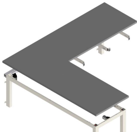
4.7.2 Het tafelblad wordt nu op het frame geplaatst. De afstand tussen de achterkant van het tafelblad en de muur mag maximaal 0,5 cm bedragen. De overige afstanden op het tafelblad moeten overeenkomen met de afmetingen op de ontvangen tekening.
