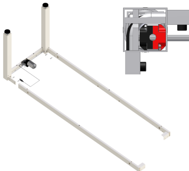
4.4.4 Monteer de lange rails met M8x16 schroeven. Het is erg belangrijk dat alle rails stevig tegen de poot worden gedrukt voordat u ze vastdraait. Zorg ervoor dat u de schroeven goed vastdraait.
