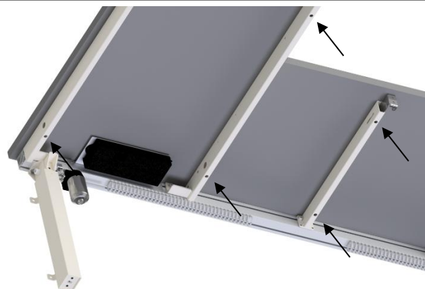
4.7.1 Bij de buitenste tafelbladsteunen wordt aanbevolen dat de beugels aan de voorrand naar het midden van het frame wijzen, zodat ze niet in conflict komen met de houten zijrand.
