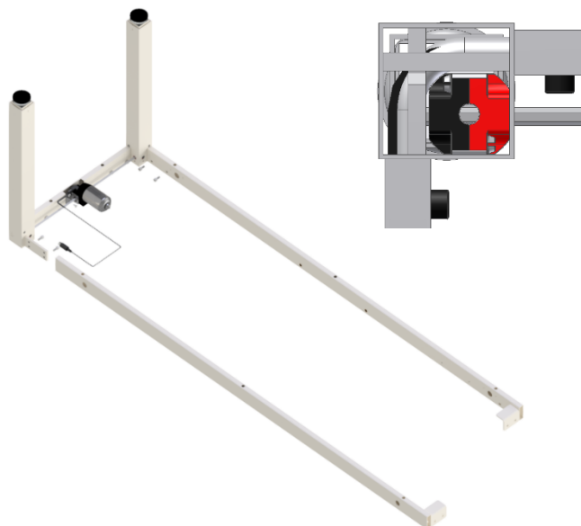
4.4.4 Monter de lange sarge med M8x16 skruer. Det er meget vigtigt at alle sarge bliver trykket hårdt ind mod benet inden de bliver efterspændt. Sørg for at spænde skruerne hårdt.
