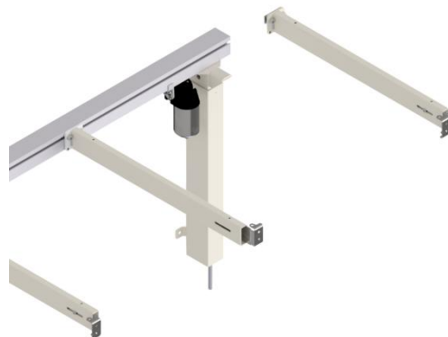
4.2.9 Den yderste højre bordpladebæring skydes ind i aluprofilet og placeres lige over benet.
