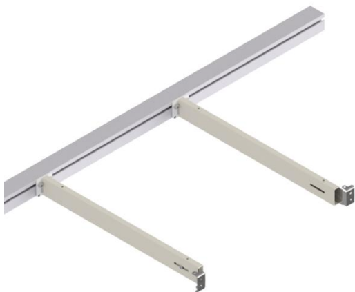
4.2.6 Bordpladebæringer som sidder imellem motorerne skydes nu ind på aluprofilet fra højre side, og fordeles så de sidder som på modtaget tegning.
