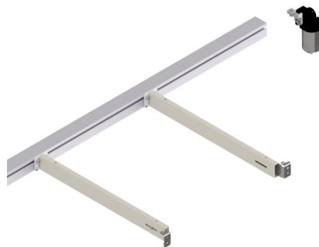
4.2.7 Den højre motor skydes ind i aluprofilet i sporet på undersiden.
