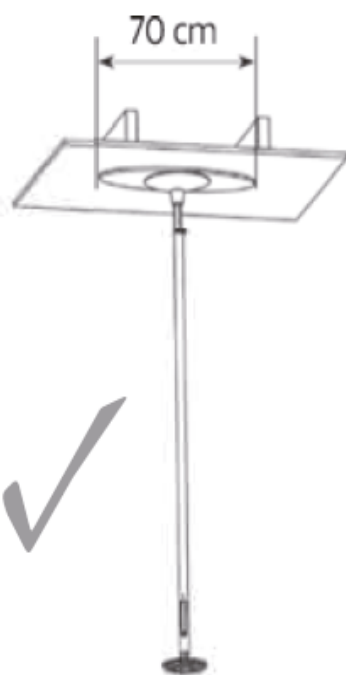
Benytt stor takplate
