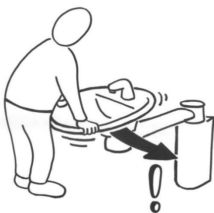
Ropox Schwenkbares Waschbecken hat eine Drehfunktion und sollte NICHT als Stützengriff oder Stehstütze benutzt werden.
