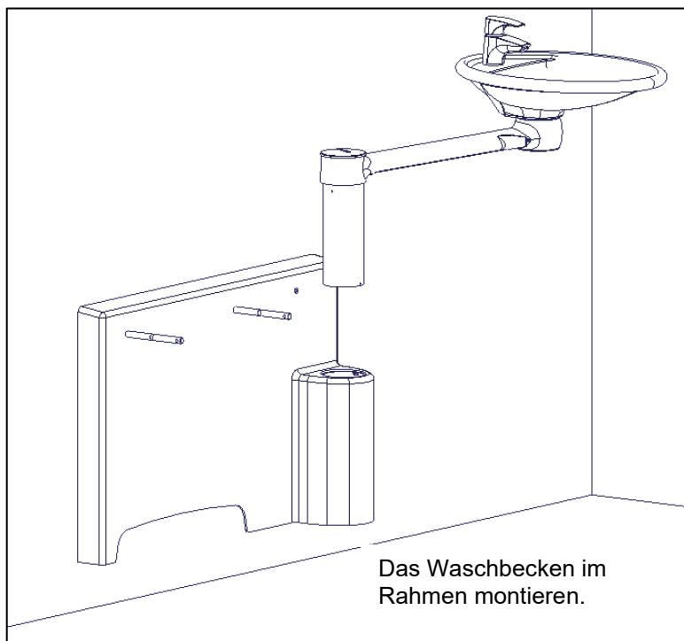
Das Waschbecken auf die obere Position verschieben. In jeder Seite 2 M5x6 Schrauben unter der Abdeckung montieren, um sicherzustellen, dass das Waschbecken nicht ausgezogen wird.
