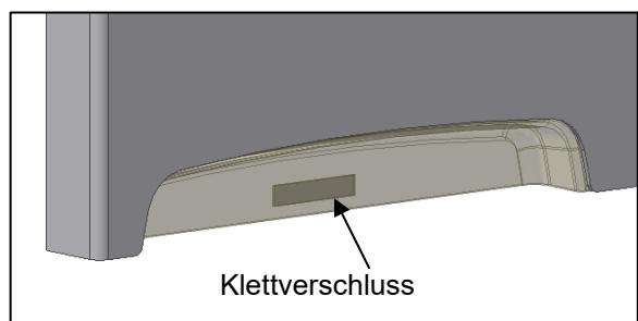
Hinter der inneren Abdeckkappe befindet sich einen kleinen Klettverschluss. Nach der Montage der Schrauben das Waschbecken in die untere Position verschieben. Das Schutzpapier vom Klettverschluss abziehen, und die innere Abdeckkappe nach oben halten, so dass sie mit der äußeren Abdeckkappe fluchtet. Gegen die Wand drücken, so dass der Klettverschluss an der Wand befestigt wird.
