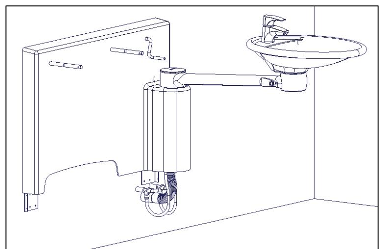
Ablaufrohr und Anschlussschläuche verbinden.
