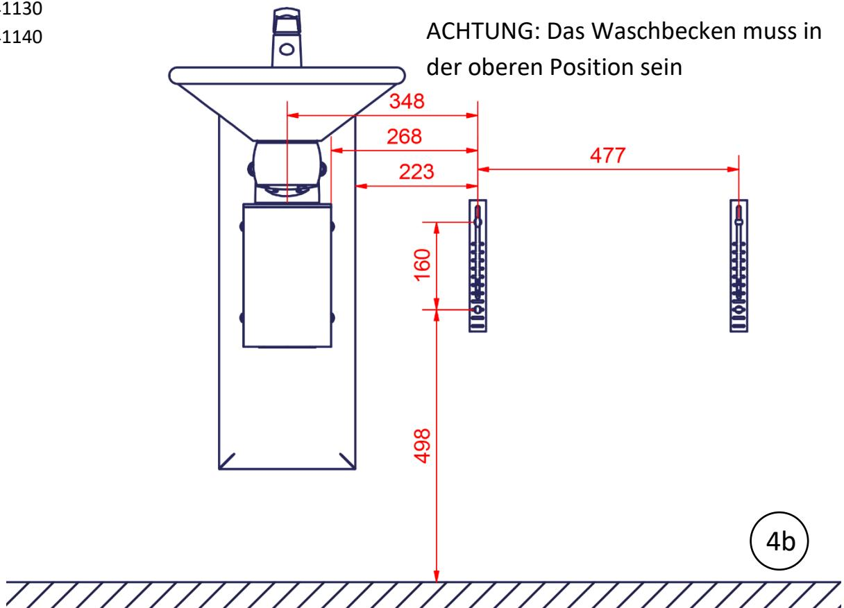
Das Produkt wird mit 4 Schrauben und Dübel geliefert was für die Montage an einer Betonwand berechnet worden ist.
