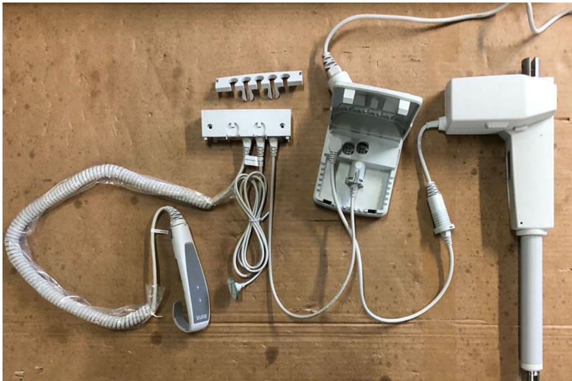
Kabelplan mit beiden Steuerungen
