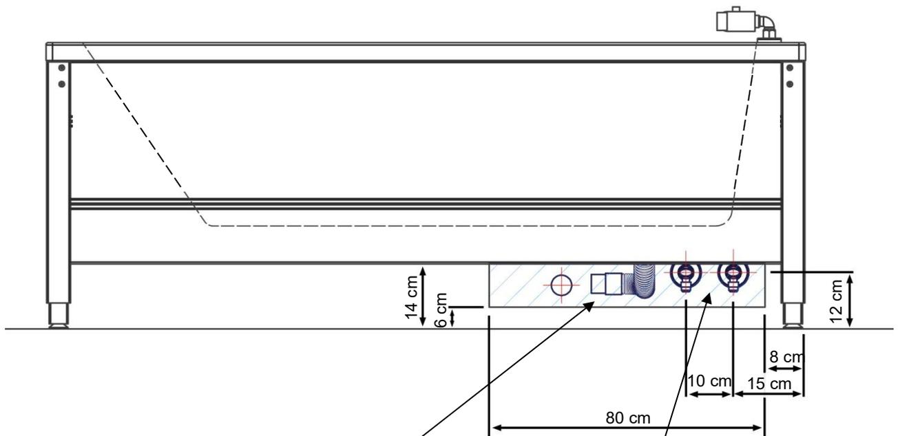
Achtung: Flexibler Ablaufschlauch (Ø40) Länge 51-150cm. Ablauf in der Wand wird mit einem Ø40x88° Biegung abgeschlossen (wird nicht mitgeliefert).
