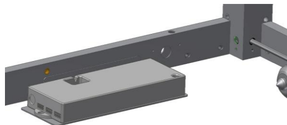
6.1.6 Die Steuerung auf dem Winkelblech mit schrauben befestigen.
