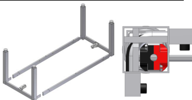
6.1.4 Herefter monteres de to forsarge. Det er meget vigtigt at både side- og forsarg bliver trykket hårdt ind mod benet inden sargene bliver efterspændt. Sørg for at spænde boltene hårdt.
