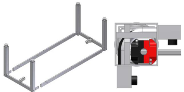
6.1.4 Jetzt die beiden Vorderzargen montieren. Wichtig: Seiten- und Vorderzargen fest gegen das Bein drücken vor Nachspannung der Zargen. Ziehen Sie die Schrauben fest an.
