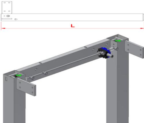
5.1.1 Überprüfen, ob die Höhe (L) der 4 Beine gleich ist. Dies lässt sich mithilfe der Sechskantwelle einstellen. Seitenzargen auf eine ebene Oberfläche legen und Beine montieren. s. Beinetikett.
