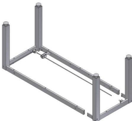
5.1.3 Montieren Sie nun die beiden Frontrahmen. Ziehen Sie die Schrauben fest an.
