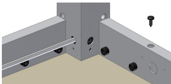
5.1.5 Die Tischplatte durch die Löcher der Zargen mit Schrauben befestigen.
