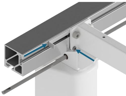
14. Die Tragarmhalterungen können bei Bedarf mit den Stellschrauben und den mitgelieferten Winkelhalterungen nach oben und unten verstellt werden.
