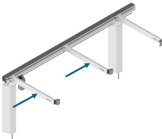
5. Setzen Sie die nächsten Tragarmhalterungen in das Aluminiumprofil ein. Die äußerste Halterung muss über dem Bein platziert werden. Ziehen Sie die Schrauben **leicht** an.
