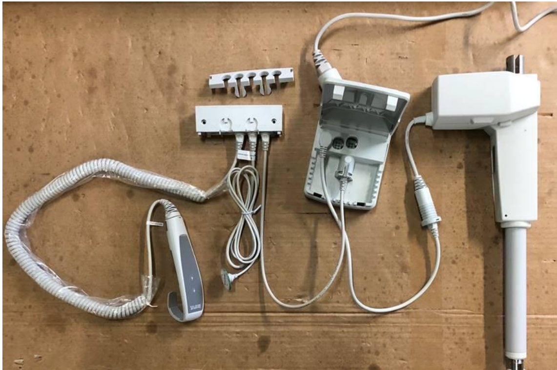
Kabelplan mit beiden Steuerungen
