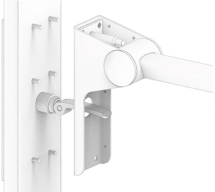
3. Schrauben Sie die Muttern fest auf die Gewindestangen. Seien Sie besonders vorsichtig, wenn Sie die beiden oberen Muttern anbringen, da der Kopf des Schraubendrehers Spuren auf der Trommel des Toilettenstützarms hinterlassen kann.
