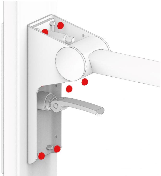
4. Schieben Sie die mitgelieferte Abdeckplatte mit Aussparung über den Spanngriff und lassen Sie sie einrasten.
