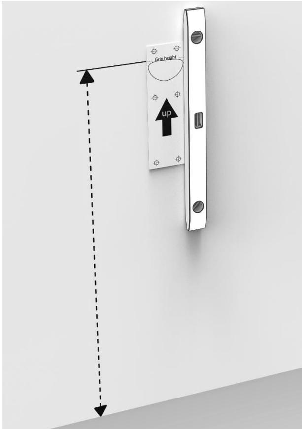
1. Verwenden Sie die mitgelieferte Montageschablone, um die Löcher entsprechend der gewünschten Höhe des Toilettenstützarms zu markieren. Die gestrichelte Linie auf der Schablone zeigt an,
