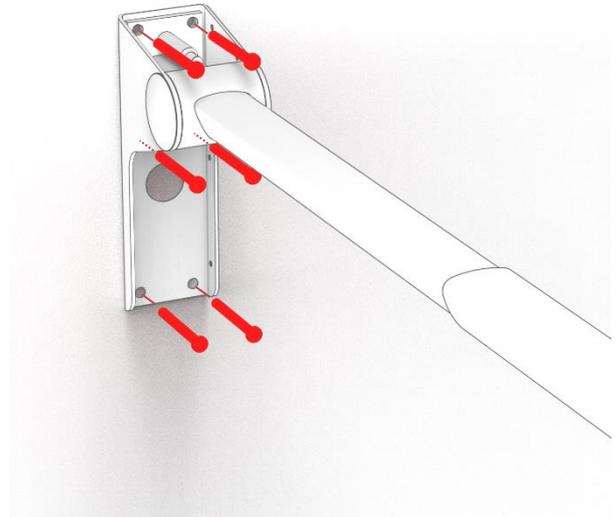
3. Schrauben Sie den Toilettenstützarm an die Wand.
