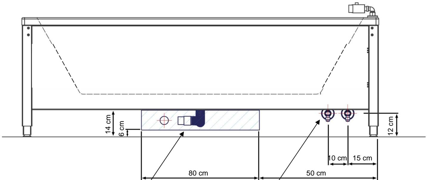
Achtung: Flexibler Ablaufschlauch (Ø40) Länge 51-150cm. Ablauf in der Wand wird mit einem Ø40x88° Biegung abgeschlossen (wird nicht mitgeliefert).
