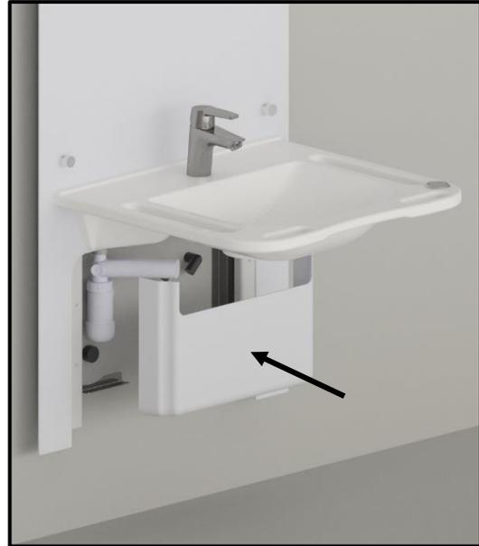
Wasser- und Ablaufschläuche wie abgebildet montieren. Montieren Sie die Installationsabdeckung wieder, indem Sie den Klettverschluss an den Halterungen befestigen. Überprüfen, ob sich alle Schläuche ungehindert bewegen können.
