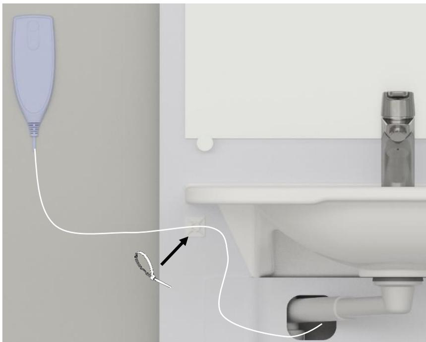
Es wird empfohlen, das Kabel zu verlegen und wie gezeigt zu befestigen, nachdem die Abdeckungen und das Waschbecken montiert wurden. Das Steuerkabel wird an den montierten Kabelhalter befestigt. Stellen Sie sicher, dass das Kabel im ausgezogenen Zustand mindestens 1 Meter über den letzten Kabelhalter hinausreicht.
