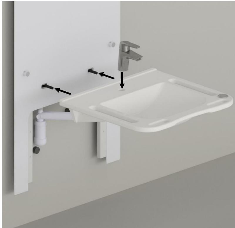
Jetzt das Waschbecken mit den beigegeführten Montageteilen für bolzmontierte Waschbecken montieren. Montieren Sie auch die Mischbatterie, aber warten Sie mit der Montage der Schläuche bis später.
