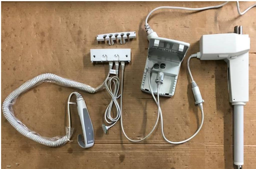
Kabeldiagramm mit beiden Bedienungen
