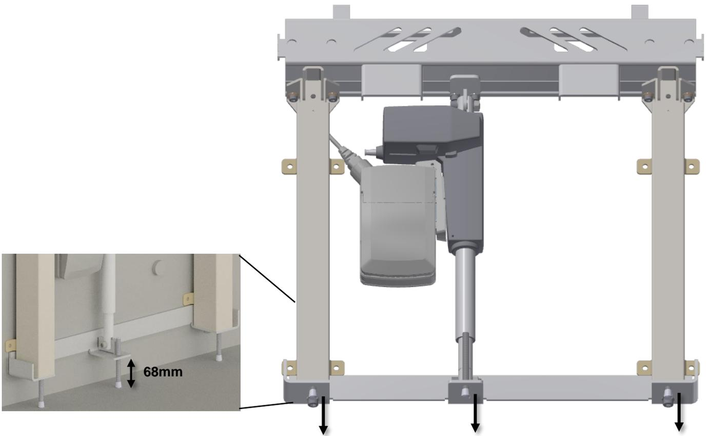
Die Stellschrauben **etwa 68mm** unter dem Bodenbeschlag einschrauben.
