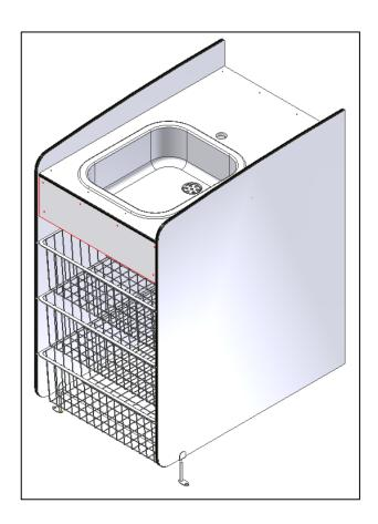
Die Korbeinheit wird an die Wand geschraubt und die Drahtkörbe können dann montiert werden.
