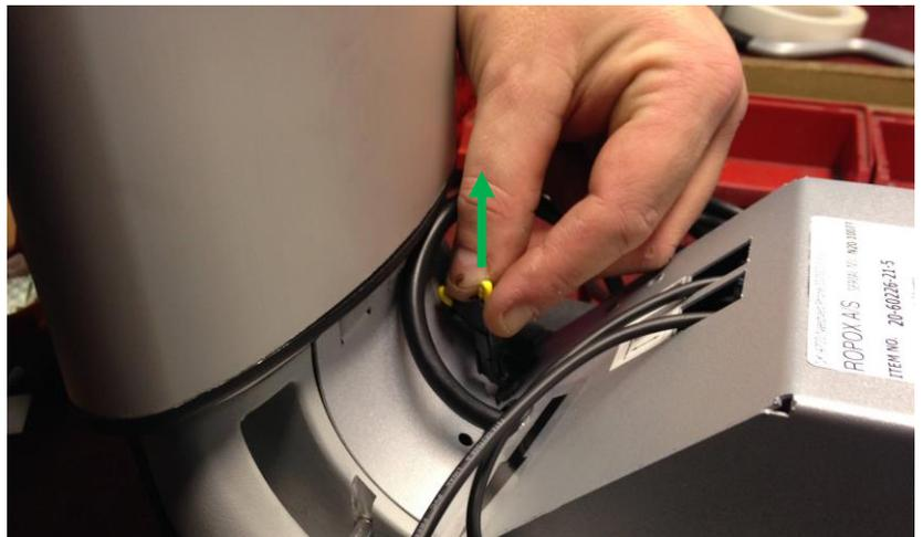
Sicherheitsstopleiste anschließen (In Abbildung-Vision Type E mit 2 Sicherheitsstopleisten)
