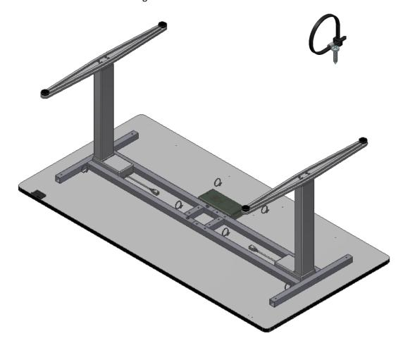
6.7. Die Kabel gemäß dem Diagramm unten montieren und sie unter dem Tisch anhand der Kabelklemmen befestigen.
