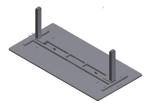
6.4. Die Füße montieren und sie mit 8 M6x25 Bolzen befestigen.
