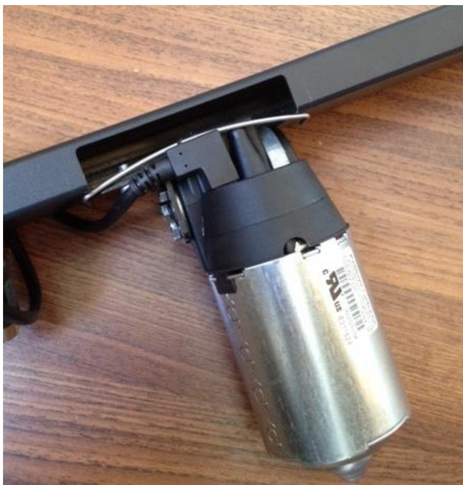
6.1.3 Fjeder for fastholdelse af motorstik monteres.
