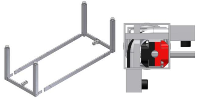
6.1.5 Jetzt die beiden Vorderzargen montieren. Wichtig: Seiten- und Vorderzargen fest gegen das Bein drücken vor Nachspannung der Zargen. Die Schrauben mit der mitgelieferten Schlüssel fest anziehen.
