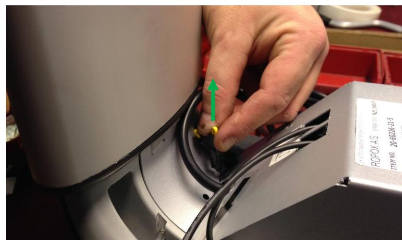
Sicherheitsstopleiste anschließen (In Abbildung-Vision Type E mit 2 Sicherheitsstopleisten)
